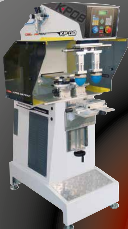
INKPRINT KP-08 2C RR Ø 90mm Con calamai ermetici ed anelli in ceramica Ø 90mm
